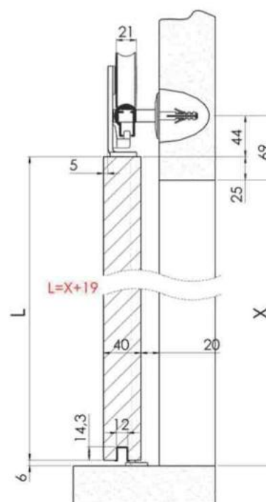
Prikaz montiranja šine sa distancerom
